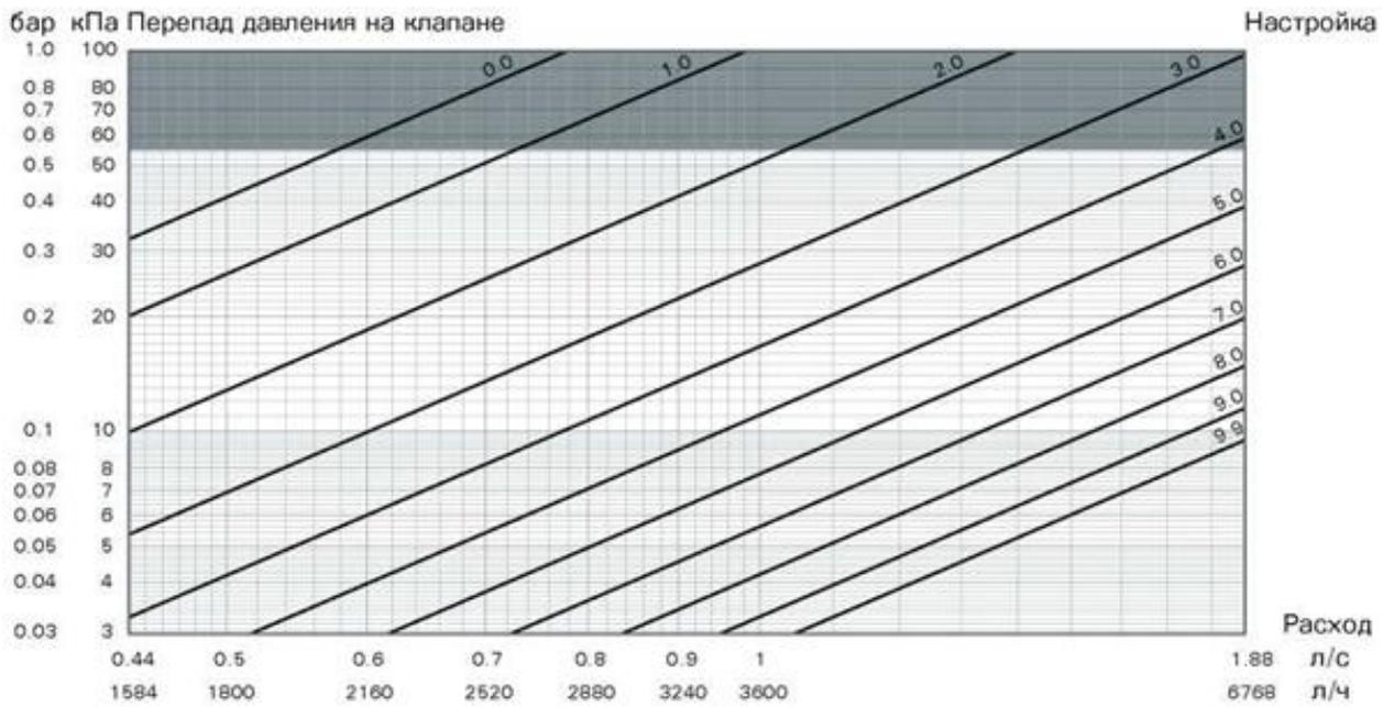
Зависимость разности перепада давления на измерительных ниппелях ручных балансировочных клапанов Ballorex Venturi FODRV 40H
