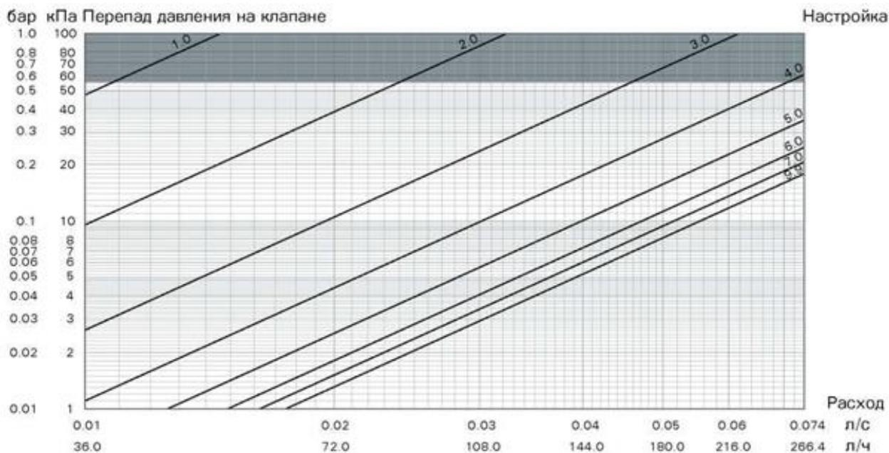
Зависимость разности перепада давления на измерительных ниппелях ручных балансировочных клапанов Ballorex Venturi FODRV 15L
