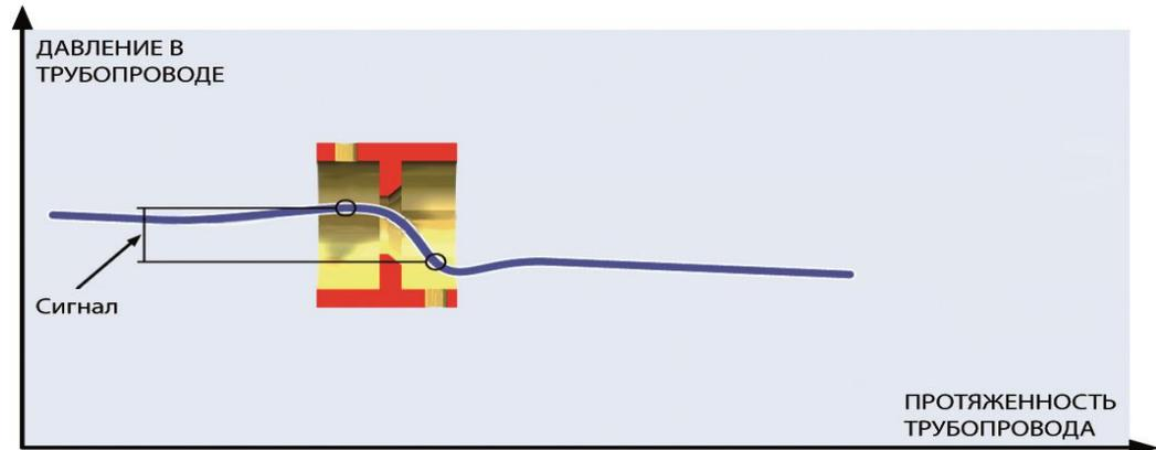
Рис. 11 Измерительная диафрагма седельчатого вентиля
