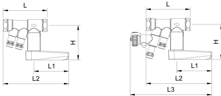
Рис. 6 Габаритные размеры Ballorex Venturi FODRV с измерительными ниппелями
