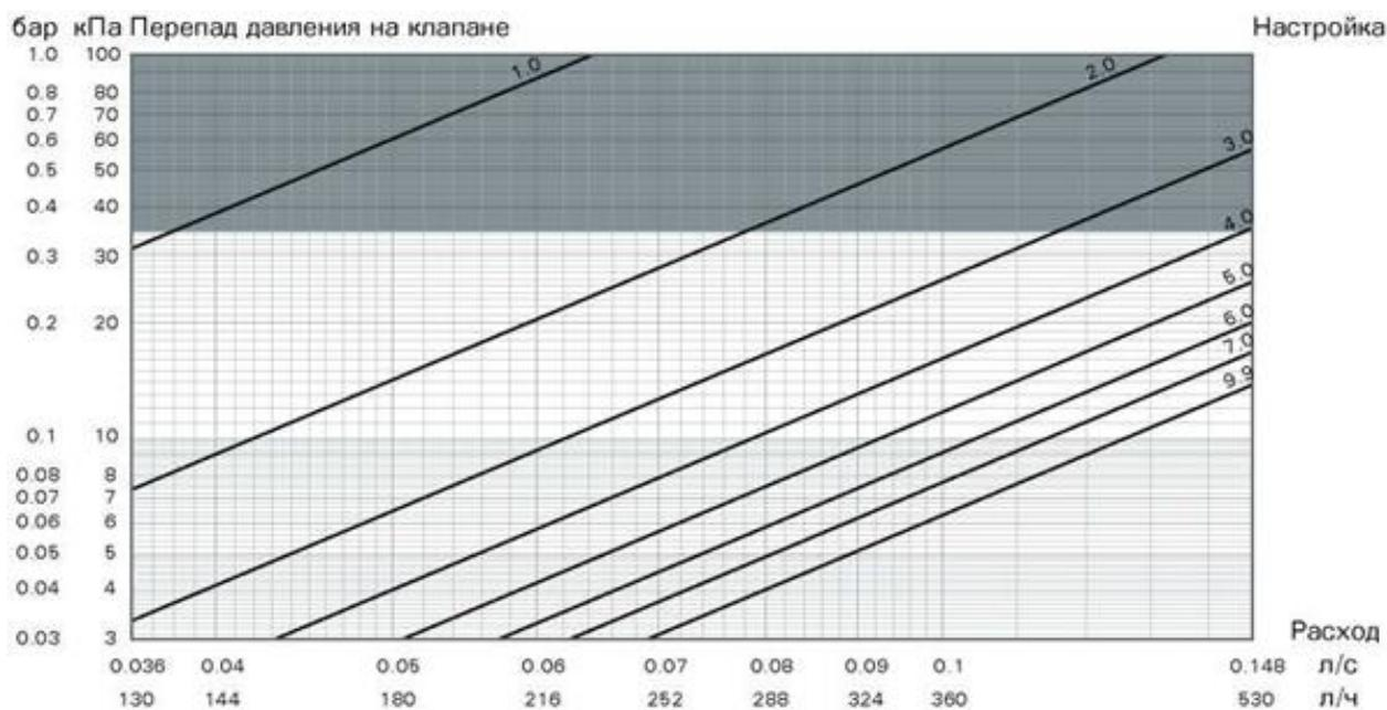
Зависимость разности перепада давления на измерительных ниппелях ручных балансировочных клапанов Ballorex Venturi FODRV 20S
