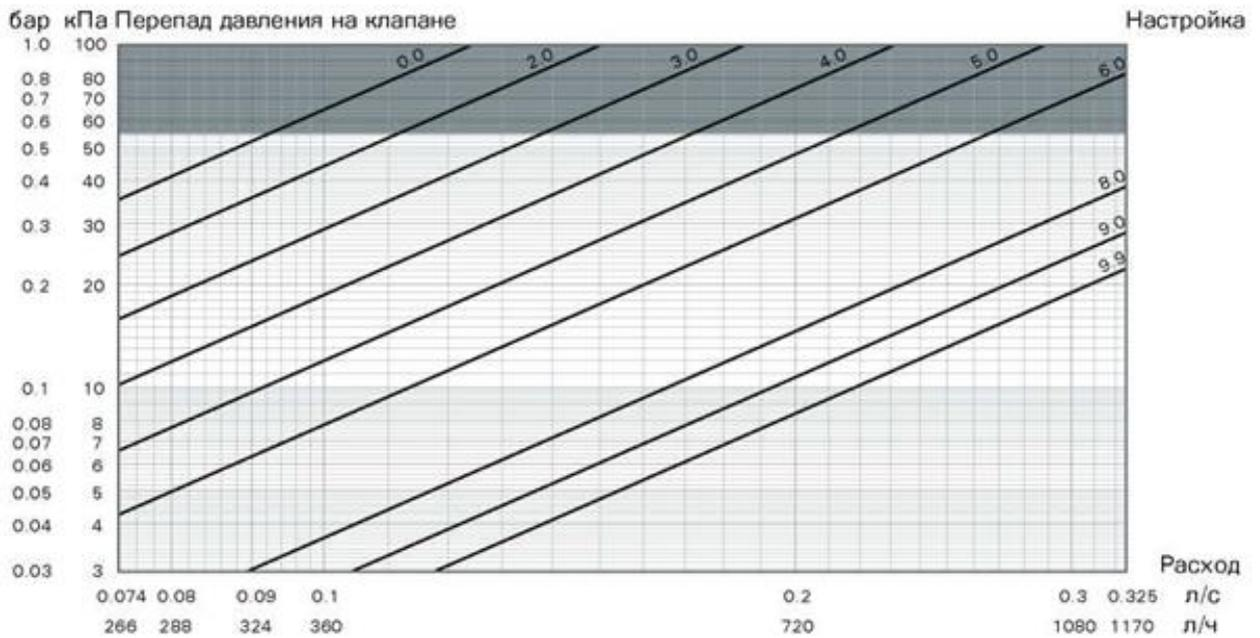
Зависимость разности перепада давления на измерительных ниппелях ручных балансировочных клапанов Ballorex Venturi FODRV 15H
