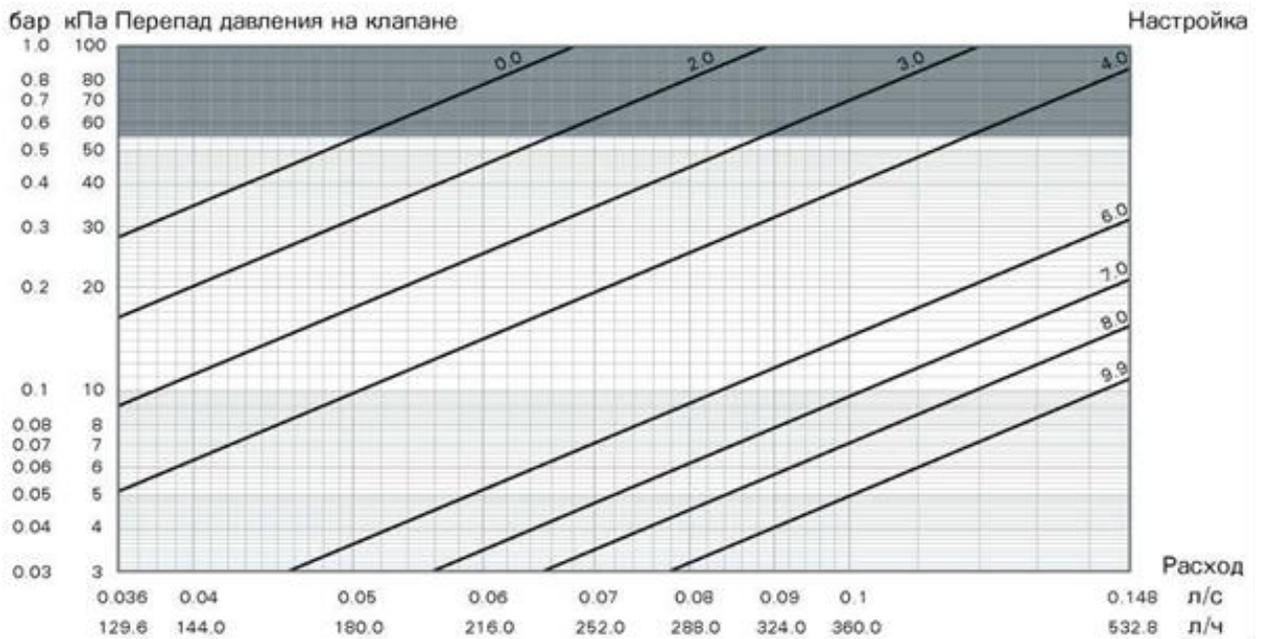
Зависимость разности перепада давления на измерительных ниппелях ручных балансировочных клапанов Ballorex Venturi FODRV 15S
