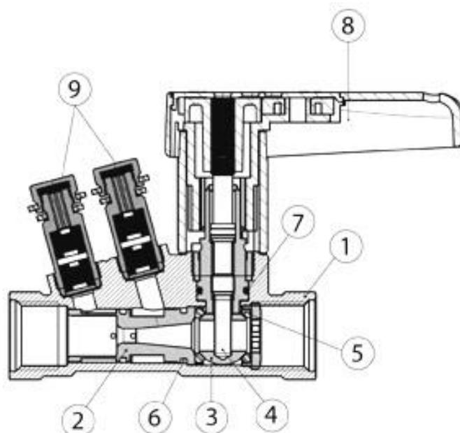
Рис. 8 Конструкция ручных балансировочных клапанов Ballorex Venturi FODRV
