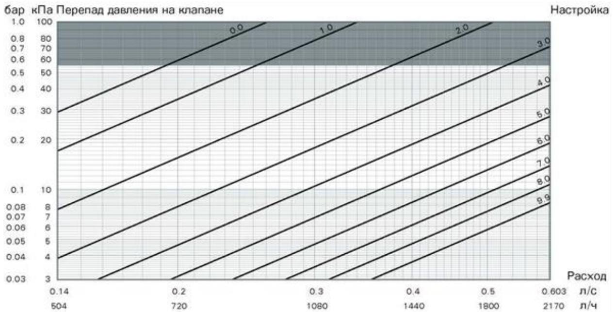
Зависимость разности перепада давления на измерительных ниппелях ручных балансировочных клапанов Ballorex Venturi FODRV 25S
