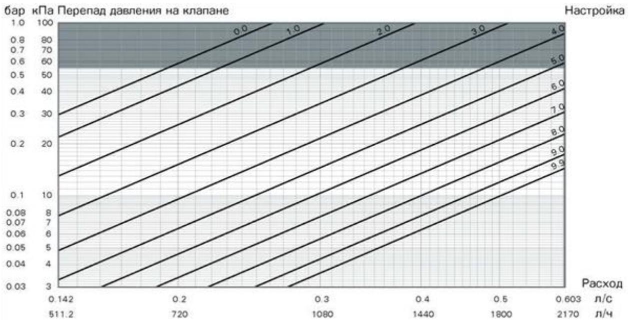
Зависимость разности перепада давления на измерительных ниппелях ручных балансировочных клапанов Ballorex Venturi FODRV 20H
