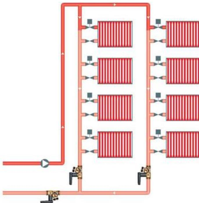
Рис. 2 Однотрубная стояковая система отопления
