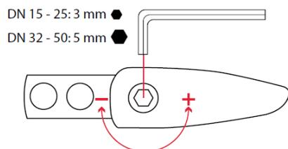
Настройка клапана производится с помощью шестигранного ключа. Значение настройки отображается в окне на ручке балансировочного клапана.
