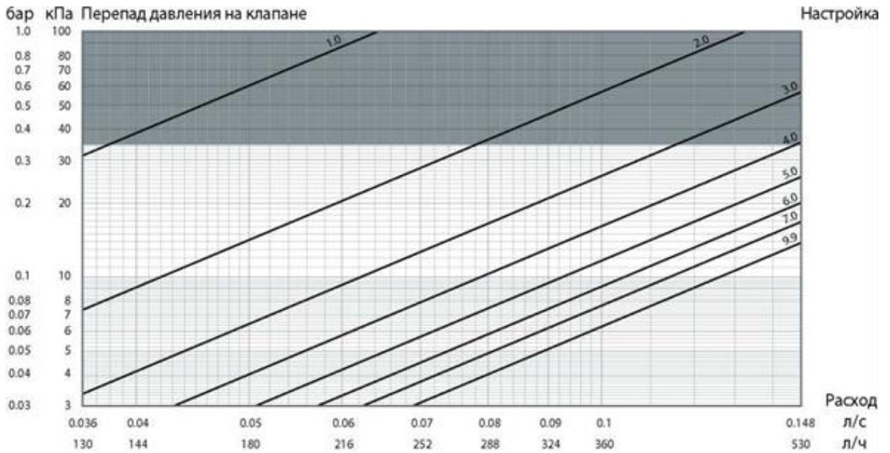
Зависимость разности перепада давления на измерительных ниппелях ручных балансировочных клапанов Ballorex Venturi FODRV 20L
