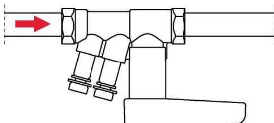
Направление потока указано стрелкой на корпусе клапана.
