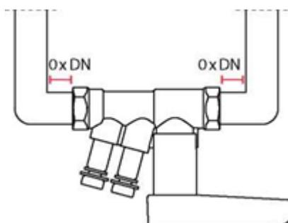
Ballorex Venturi может быть установлен непосредственно до и после отвода, тройника и т.д.
