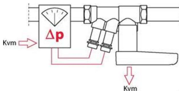
Определение расхода может быть проведено измерительным прибором Ballorex. В случае применения другого измерительного компьютера требуется единственный раз ввести значение Kvm, которое указано на ручке балансировочного клапана.
