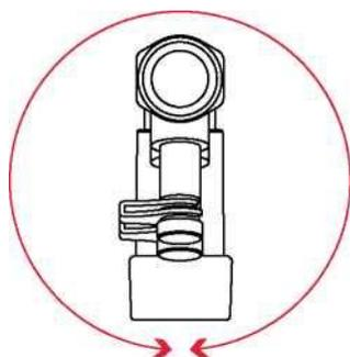
Ballorex Venturi может быть установлен в любом положении относительно оси трубопровода.
