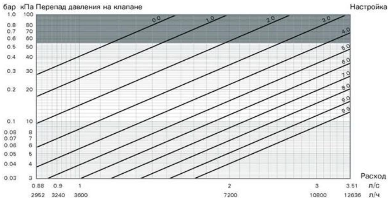
Зависимость разности перепада давления на измерительных ниппелях ручных балансировочных клапанов Ballorex Venturi FODRV 50H
