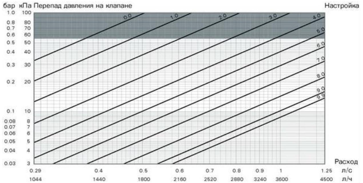
Зависимость разности перепада давления на измерительных ниппелях ручных балансировочных клапанов Ballorex Venturi FODRV 25H
