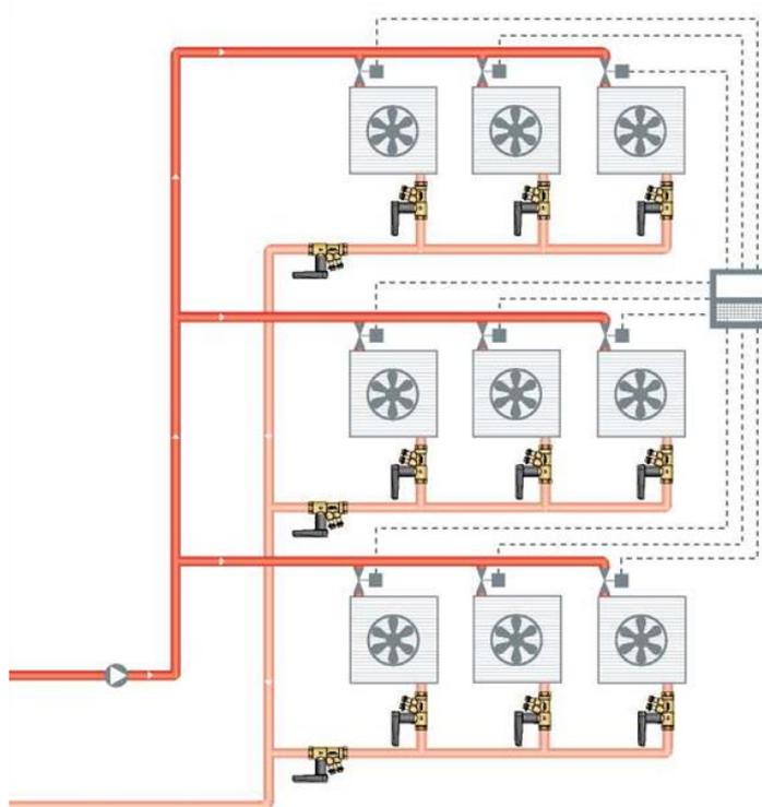
Рис. 3 Система теплоснабжения тепловентиляторов
