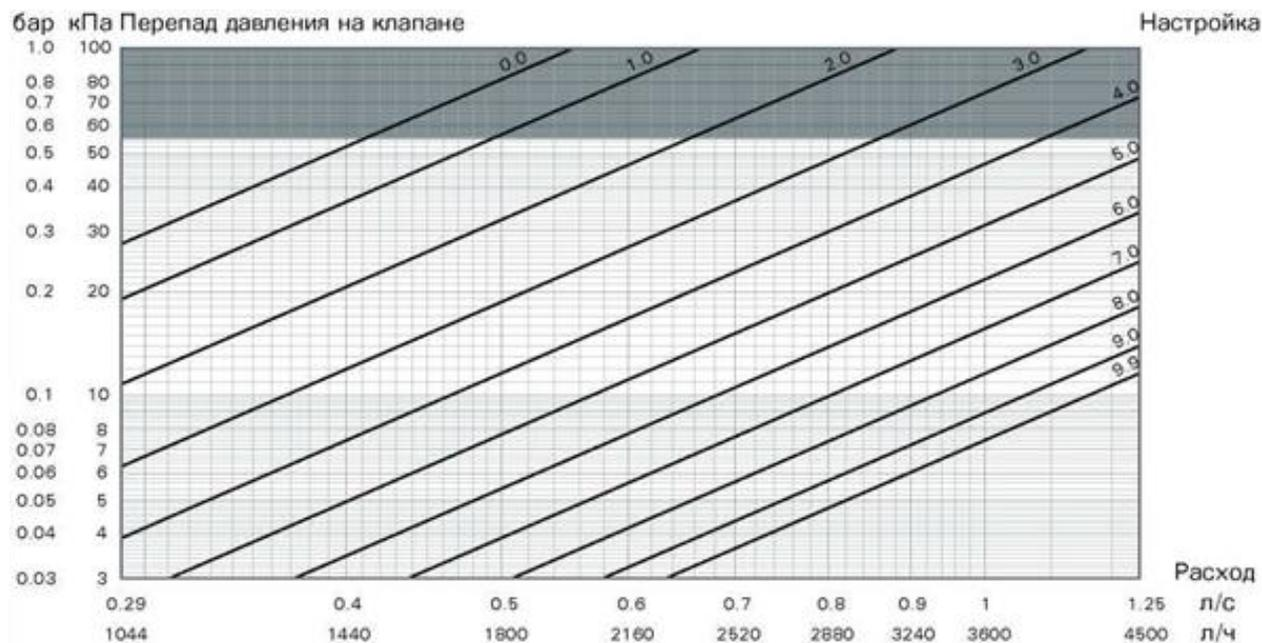
Зависимость разности перепада давления на измерительных ниппелях ручных балансировочных клапанов Ballorex Venturi FODRV 32H
